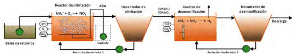
Figura 15. Proceso Biomox de la EDAR Postdam Nord en Alemania (Wehrle, 2015).
