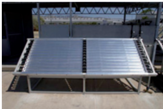
Figura 3. Captador Cilindro-Parabólico Compuesto (CPC) instalado en la Plataforma Solar de Almería.
