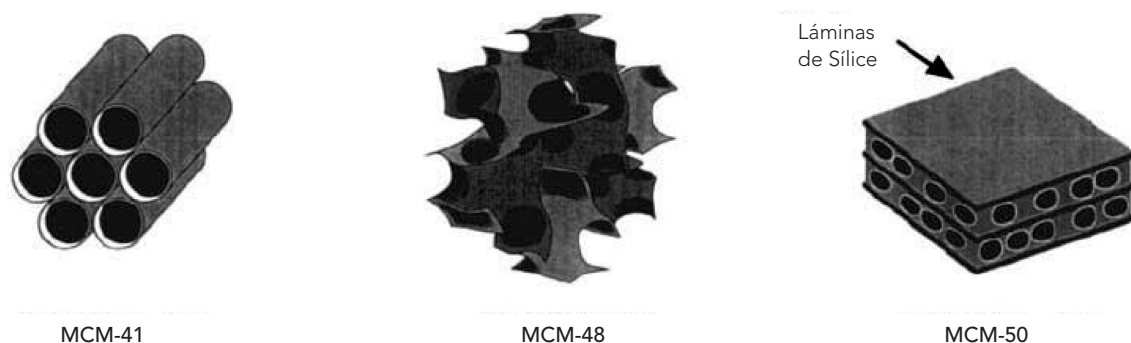
Figura 4. Representación esquemática de los materiales correspondientes a la familia M41S.
