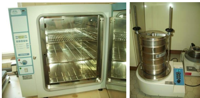
Figura 2. 15. Estufa de secado y esterilización (izquierda), y agitadora (derecha) utilizadas para los análisis granulométricos del sedimento hiporreico.
