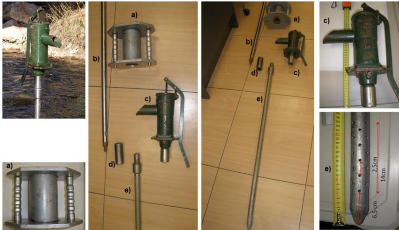
Figura 2. 12. Bomba y aparataje utilizados para el muestreo de la zona hiporreica: a) martillo; b) tubería guía deslizante para el martillo; c) bomba manual Bou-Rouch; d) adaptador tubería martillo-tubería toma muestra; e) tubería toma muestra con agujeros ( \varnothing = 0,5 cm) en la parte distal para la toma de muestra.
