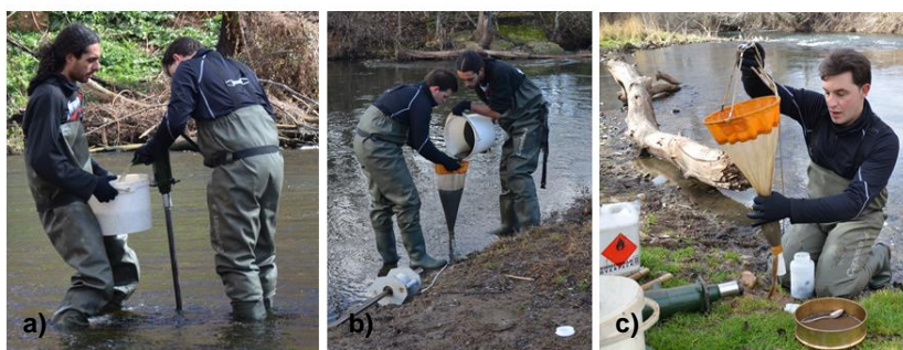
Figura 2. 13. Proceso secuencial de los trabajos realizados para la obtención de la muestra hiporreica: a) bombeo de la zona hiporreica para la obtención de la muestra; b) filtrado por la red de 63 µm de la muestra; c) conservación de la muestra con etanol al 70%.
