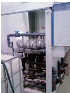
Detalle de la planta piloto de electrolisis con ánodos de diamodos conductor.
