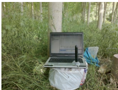
Determinaciones in situ sobre el agua subterránea: perfil de conductividad eléctrica de la columna de agua y descarga de datos del datalogger (CTD Diver).
