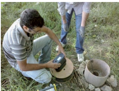
Determinaciones in situ sobre el agua subterránea: perfil de conductividad eléctrica de la columna de agua y descarga de datos del datalogger (CTD Diver).
