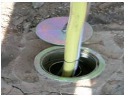
Toma de muestra en piezómetro.
