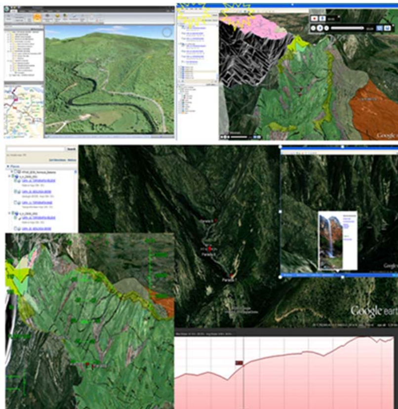
Figura 6. Capturas de vuelos virtuales 3D con Terra Explorer y Google Earth, superponiendo capas cartográficas geológicas y LIGs con información fotográfica en la georuta elaborada con diferentes LIGs.
