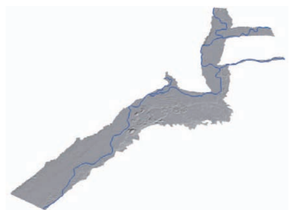
Figura 12. Superficie del techo de las gravas
