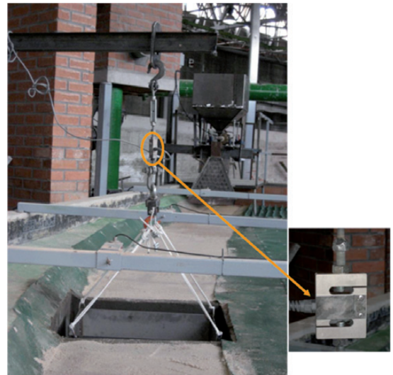
Figura 15. Trampa de sedimentos y célula de carga
