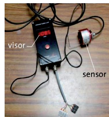
Figura 12. Limnómetro en detalle
