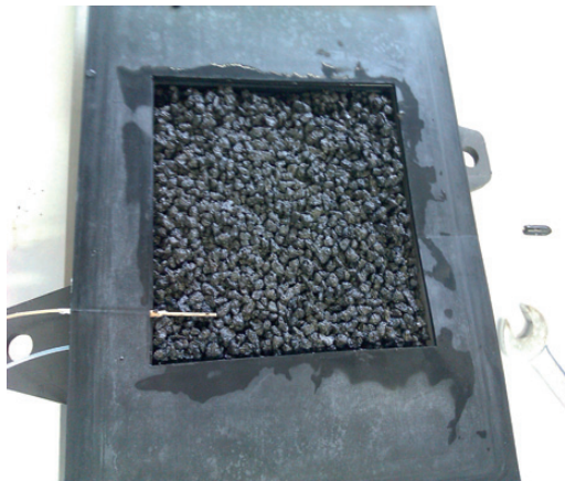
Figura 8. Fotografía de la disposición las partículas de grafito en la cámara anódica de la ECELL
