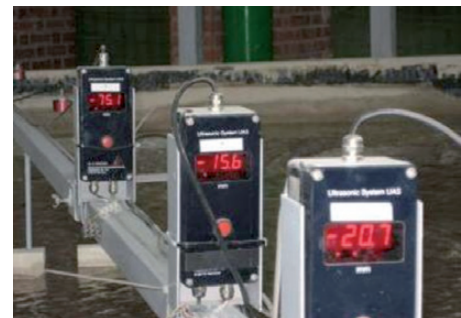
Figura 12. Limnómetro en detalle
