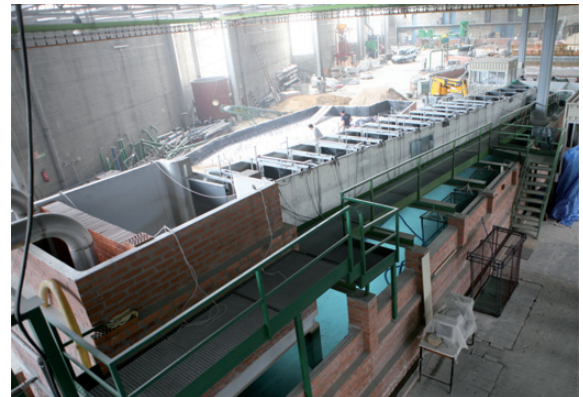
Figura 1. Modelo físico de la escala de peces en el Laboratorio de Hidráulica del CEH
