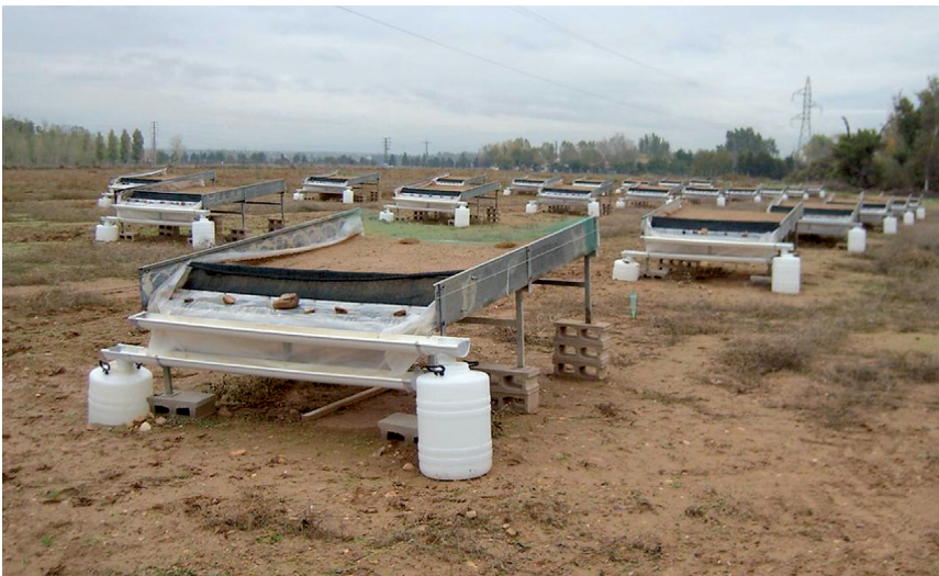
Figura 6. Vista panorámica de las mesas de escorrentía en la Finca de La Canaleja (INIA) para el estudio de movilidad de contaminantes.
