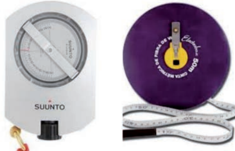
Figura 8. Medición de alturas: aparatos de medida utilizados, Suunto para las visuales a la copa y a la base del árbol, y cinta métrica para posicionarse a una distancia conocida
