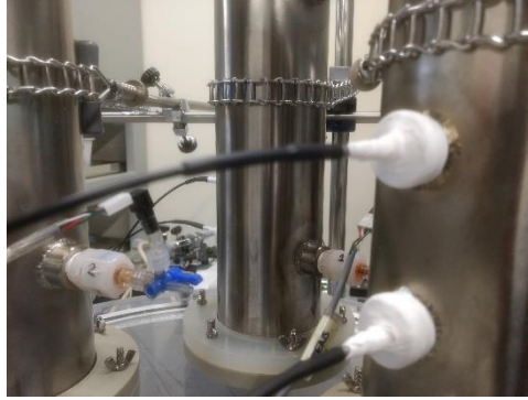
Figura II.7. Imagen de las columnas empleadas en el ensayo de infiltración a escala laboratorio.
