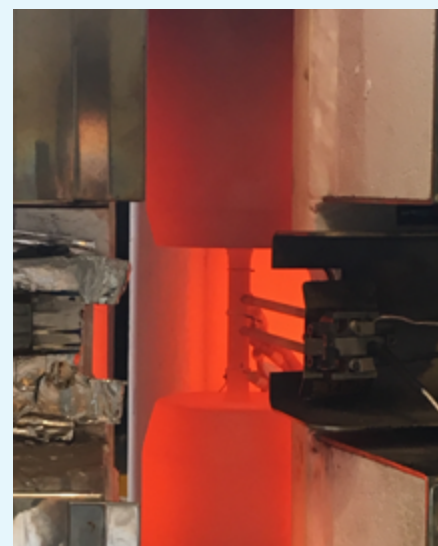
IDONIAL: Tracción con extensómetro
