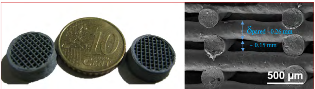
■ Figura 1. Fotografías de los monolitos de geometría de canal rectangular: (a) comparación de su tamaño con un moneda de 10 céntimos de euro; (b) micrografía en un microscopio FESEM de la sección transversal del monolito.
