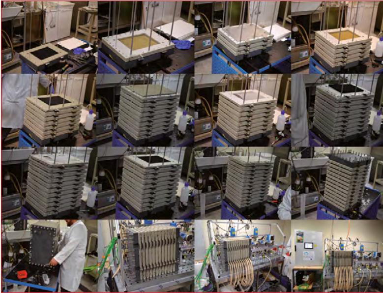
■ Figura 5. Secuencia de montaje del sistema de Celda de Desalación Microbiana piloto.
