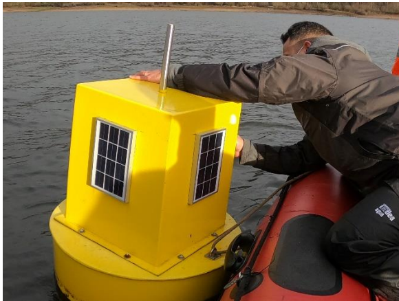
Figura 18. Instalación inicial de las boyas con nodos Libelium en el embalse de As Concha.
