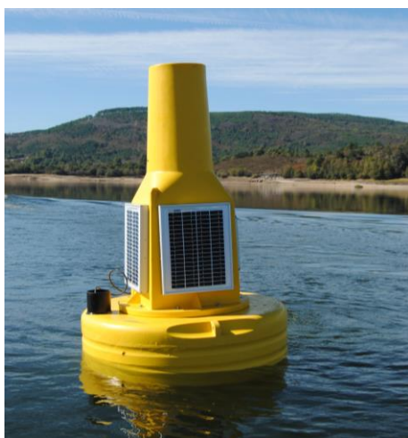
Figura 8. Boya del fabricante YSI instalada en el embalse de As Conchas (Ourense).
