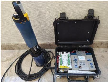
Figura 9. Sonda multiparamétrica EXO-3, datalogger Storm-3, cable de comunicación, batería y maletín hermético.
