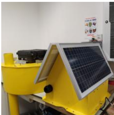
(b) Ensamblado de la boya con el nodo Ysi
