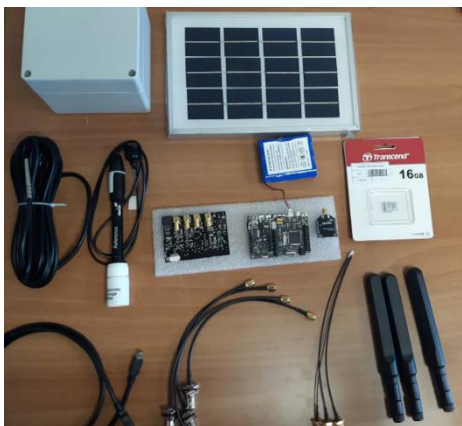
Figura 6. Componentes de un nodo de Libelium. En la parte superior izquierda se encuentra una caja estanca (IP65) seguida del panel solar. En el medio de la imagen de izquierda a derecha se encuentran: sensores, placa de interfaz con los sensores, Waspote, módulo de comunicación y tarjeta microSD. En la parte inferior: cable USB mini-B para descargar el programa al nodo desde un ordenador, los conectores y las antenas.
