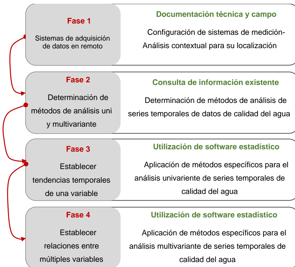
Figura 1. Fases del procedimiento seguido para el análisis estadístico de las series temporales de calidad del agua recogidas con sensores del proyecto CianoMOD. Izquierda: objetivo de la fase, derecha: resumen del procedimiento seguido.
