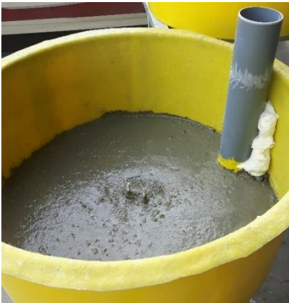
Figura 14. Contrapeso interno de los flotadores a emplear en la Albufera de Valencia.
