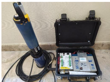
Figura 9. Sonda multiparamétrica EXO-3, datalogger Storm-3, cable de comunicación, batería y maletín hermético.
