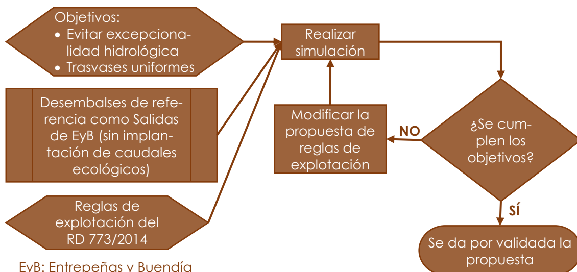
Figura 72. Esquema de la metodología planteada para la revisión de las Reglas de Explotación, adaptada de la realizada para la definición de excedentes
